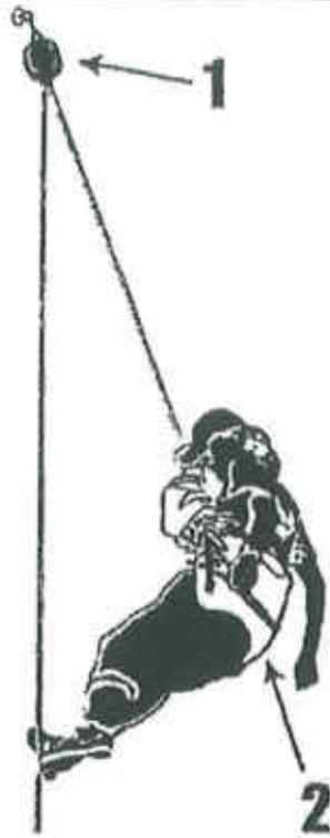
Система спасения и эвакуации, использующая индивидуальное спасательное устройство (ИСУ), предназначенное для спасения работника с высоты самостоятельно.
